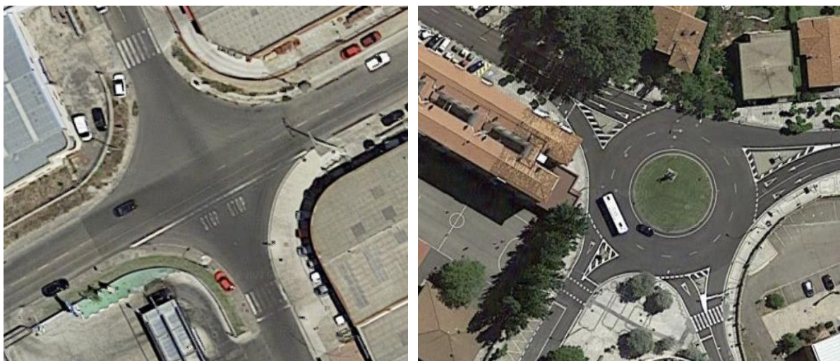
Ilustración 59: Comparación entre la degradación del marcado vial en la Calle de Bélgica del polígono industrial de Palencia (izq.) y la Avenida Simón Nieto
