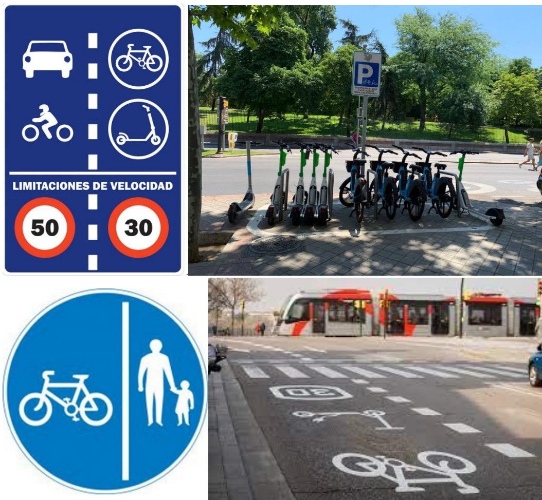
Ilustración 33: Ejemplos de buenas prácticas de señalización ciclista y VMP
