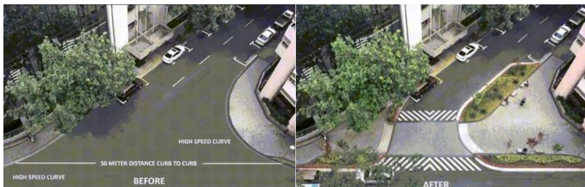
Ilustración 52: Ejemplo del antes y del después de un proyecto de rediseño de acceso a una calle residencial
